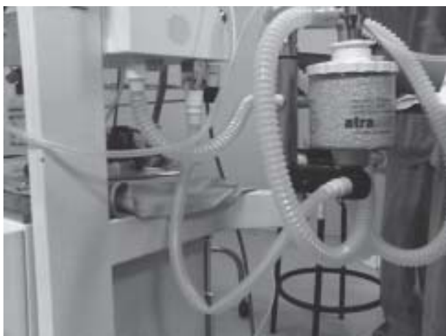
Figura 3 – Angulação da Mangueira Inferior Bloqueando o Fluxo de Gases.
